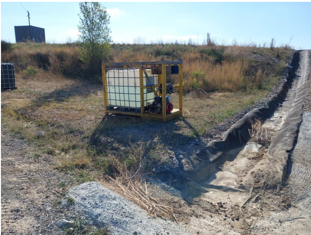
Photo 4 : Réserve d'eau et kärcher pour lavage véhicules sortants du site
